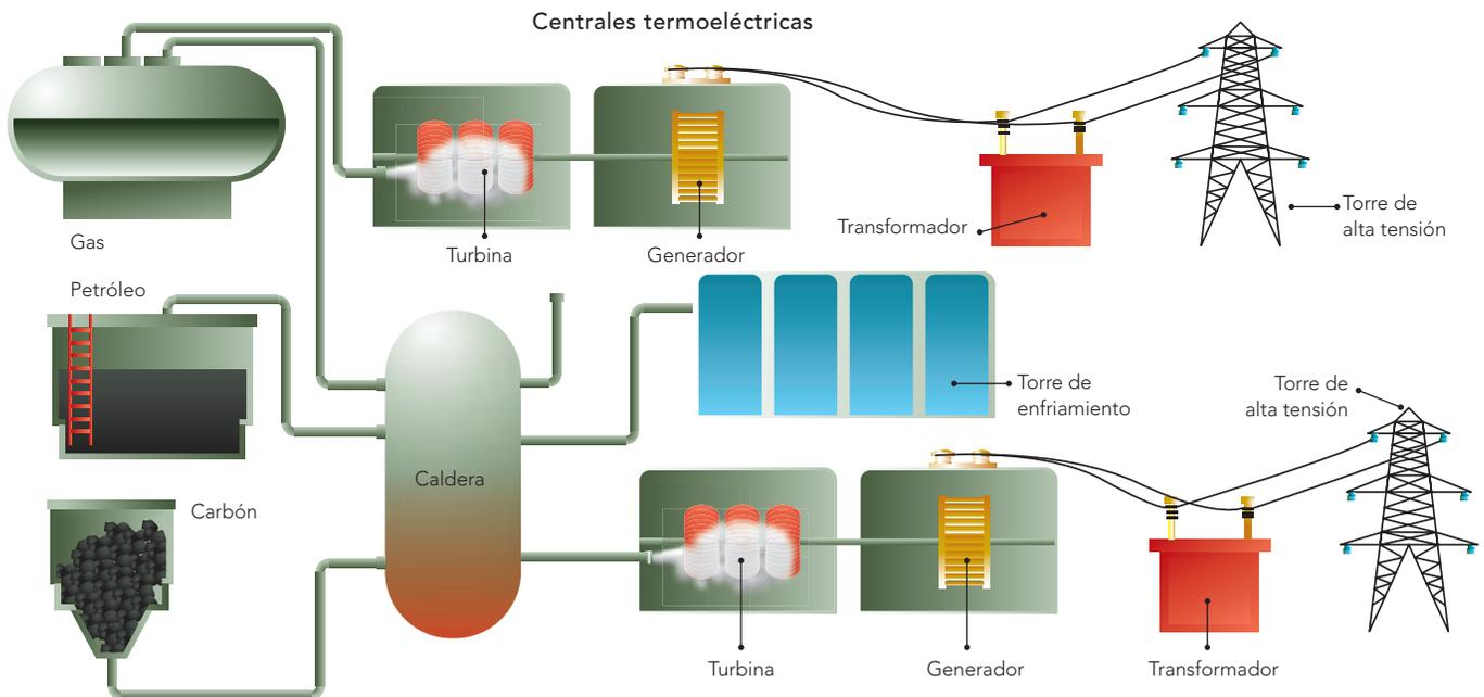
Muchas de estas centrales eléctricas utilizan carbón como combustible para calentar el agua. El vapor que sale de las calderas hace girar las aspas de grandes turbinas. Estas turbinas se encuentran conectadas a otras máquinas llamadas generadores, que producen electricidad al ponerse en movimiento. La energía que se genera en la central eléctrica se transmite a
