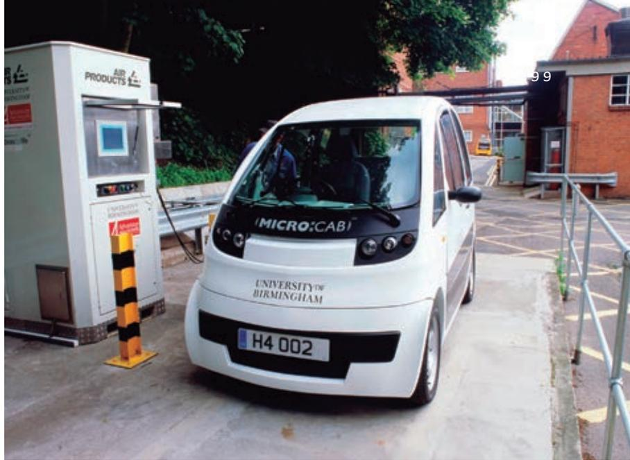
Un automóvil, cuyo combustible es el hidrógeno, funciona como uno eléctrico, pero lo alimenta una pila de hidrógeno, material que se combina con el oxígeno del aire en una celda para generar electricidad. Existen dos tipos de motores que emplean hidrógeno: los motores de combustión, que lo utilizan como si fuera gasolina, es decir, lo queman en un motor de explosión, y los motores de conversión de pila de combustible, que utilizan el hidrógeno para producir electricidad.
